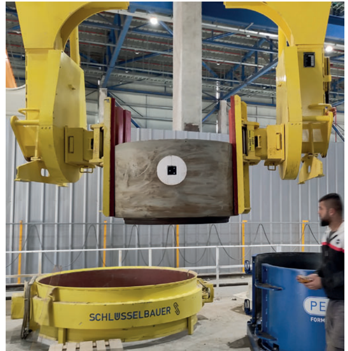
Готовый канал с деталями соединения труб собирается в форме, куда затем заливается СУБ
