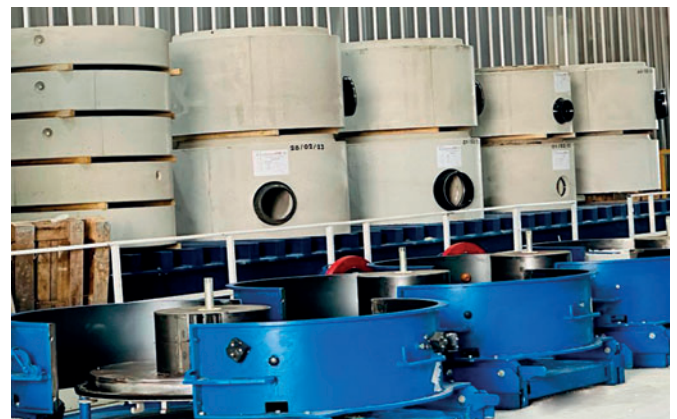
Гидравлический поворотный захват используется для извлечения оснований бетонных колец Perfect из форм и поворота их в положение для дальнейшего монтажа
