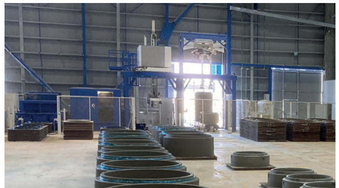
Производство и укладка изделий на поддоны, очистка и смазка поддонов полностью автоматизированы
