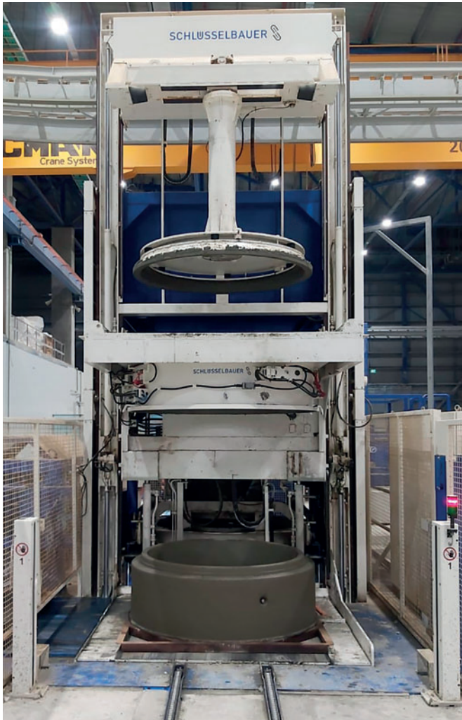
Система Magic для серийного производства доборных колец номинальной шириной 800, 1000, 1250 и 1500 мм
