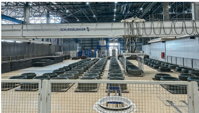
Зона выдерживания стандартизированных доборных колец с автоматическим краном Transexact
